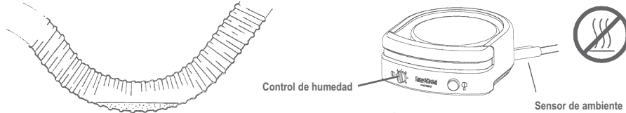
Exceso de condensación en el tubo de suministro.
